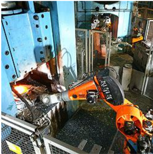
Roboter verketten Gesenkschmiedeprozess
